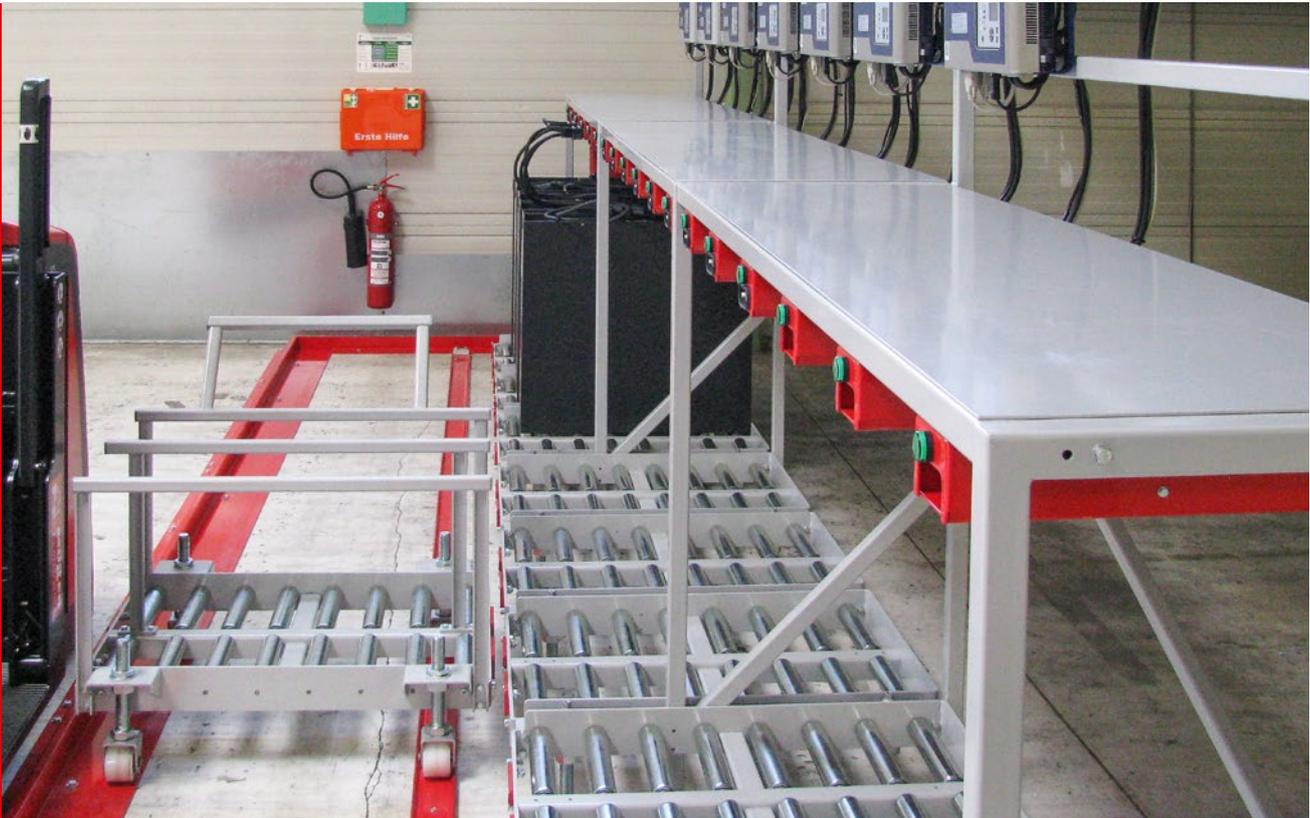
Der mehrschichtige Einsatz von elektrischen Flurförderzeugen erfordert das Wechseln von Batterien.
