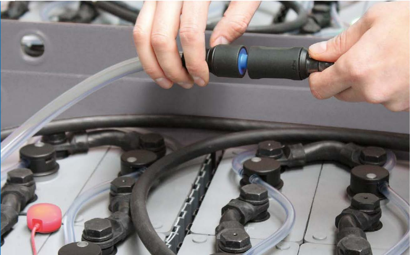
Einer der wichtigsten Bestandteile für die Funktion von Traktionsbatterien mit Blei-Säure Technik ist der Elektrolyt; eine Lösung aus Schwefelsäure und Wasser. Bei der Wiederaufladung von Batterien wird Wasser durch Elektrolyse in Wasserstoff und Sauerstoff umgewandelt. Dieser Wasserverbrauch muss bei Batterien mit Flüssigelektrolyt kurz vor Ladeende mit entmineralisiertem Wasser ausgeglichen werden. Für die Reinheit des Nachfüllwassers gelten hohe Anforderungen.
